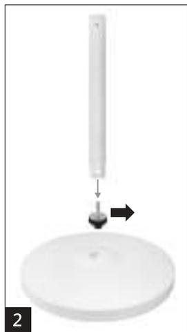
2. 請先將下連接杆(長)下方的底盤螺絲取出。
