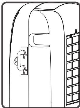
圖 1：主機上的U型水管
