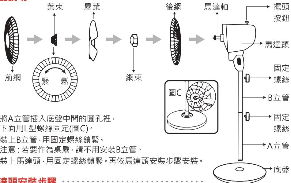
01. 將A立管插入底盤中間的圓孔裡，下面用L型螺絲固定(圖C)。
